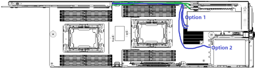
图 5-39 i24LM6 节点接线
