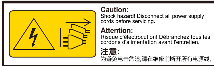
图 9-2 多电源安全防护
